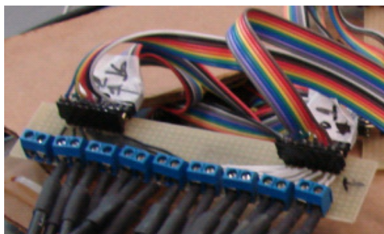
Figura 18: Borneira de saída da placa de multiplexação para os eletrodos.
